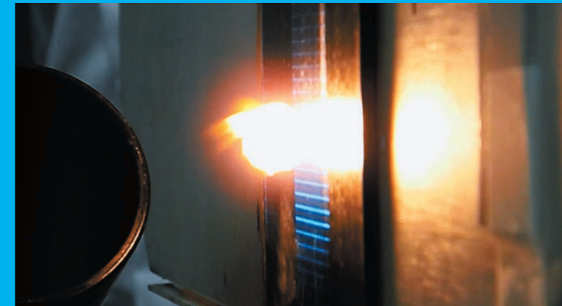
Trennmittelabtrag mit dem Excimerlaserstrahl (30 x 2 mm 2 ) bei 308 nm.
